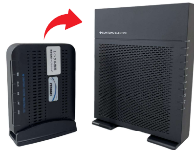
通信端末 (10G-ONU) 外形寸法 184×65×231mm
